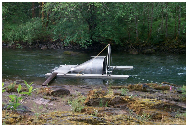
„ Rotary Screw Trap“ zur Kontrolle abwandernder Smolts
